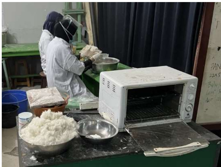
Gambar 2. Proses Pembersihan limbah bulu ayam dan pengeringan
